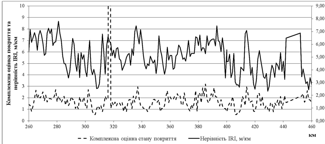
Рисунок 3 — Порівняльний аналіз ділянки автомобільної дороги М-14 за показником комплексного коефіцієнта стану покриття та нерівністю дорожнього покриття за міжнародним індексом нерівності IRI
